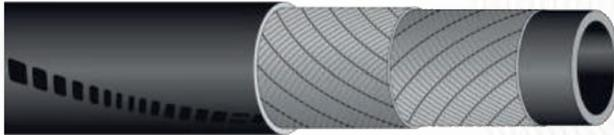
Tubo flessibile per mandata di vapore saturo ad una temperatura di 165°C e ad una pressione di esercizio massima di 6 bar, con rinforzo tessile.
